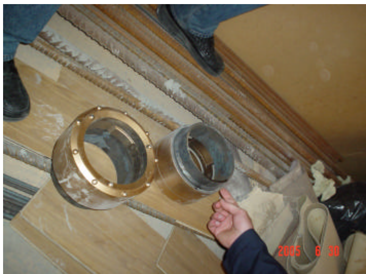
Fig 3 Ringborrkrona som monteras vid rörspetsen.
